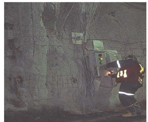
Des systèmes de surveillance souterrains vérifient constamment le niveau de radon et affichent les résultats comme un feu de circulation.
